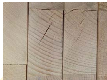
Figura 20: Fendas en los extremos en haya al salir del secadero (CRITTBois, 2018)
