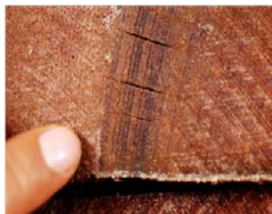
Figura 21: Colapso (retracción celular) (ABARCO EXPERTISES)
