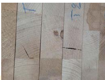
Figura 20: Fendas en los extremos en haya al salir del secadero (CRITTBois, 2018)
